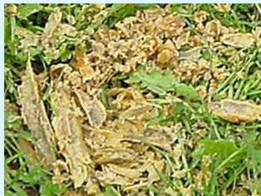
Nach ein paar Schlägen mit einem Schraubenzieher fiel der Kesselstein von den Heizstabwindungen einfach ab.
